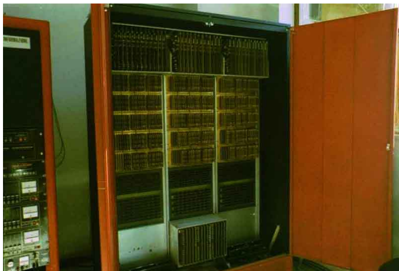
Porte aperte: l'unità audio del Tau2 . A sinistra, parte dell'unità di controllo.
